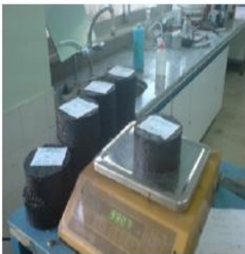
شکل ۶ - چگونگی ساخت و آماده سازی نمونه ها جهت انجام آزمایش مارشال
