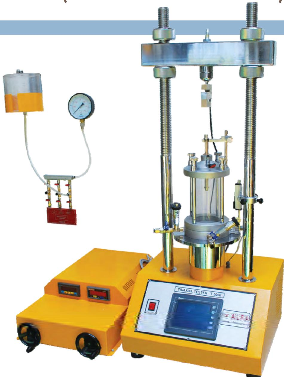
هر یک از تنش های  $\sigma_1$  و  $\sigma_3$  را می توان به دلخواه کنترل کرده و تغییر داد. در دستگاه سه محوری واقعی (True Triaxial) تنش  $\sigma_2$  نیز قابل تغییر است. همچنین امکان کنترل زهکشی نمونه و اندازه گیری فشار آب حفره ای نیز وجود دارد.
