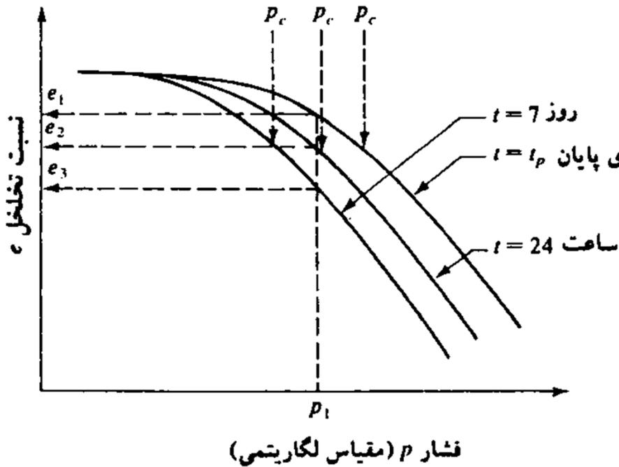
□ با افزایش دوام بارگذاری، مقدار تحکیم ثانویه نمونه افزایش می یابد که این موضوع باعث کاهش نسبت تخلخل  $e$  می شود.
