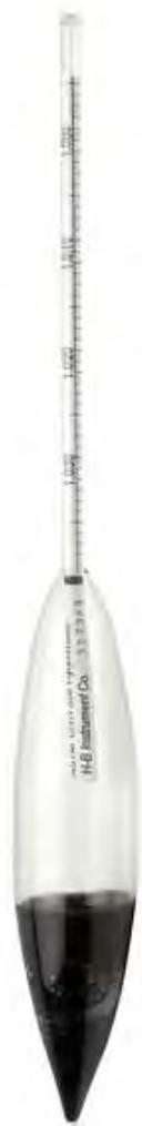
آزمایش هیدرومتر (Hydrometer Test) برای دانه بندی بخش ریزدانه خاک (عبوری از الک شماره ۲۰۰) استفاده می شود. ابزار اصلی در انجام این آزمایش هیدرومتر است که لوله ای مدرج نشان دهنده مقدار ناخالصی های معلق در آب در اطراف مرکز ثقل لوله است.
