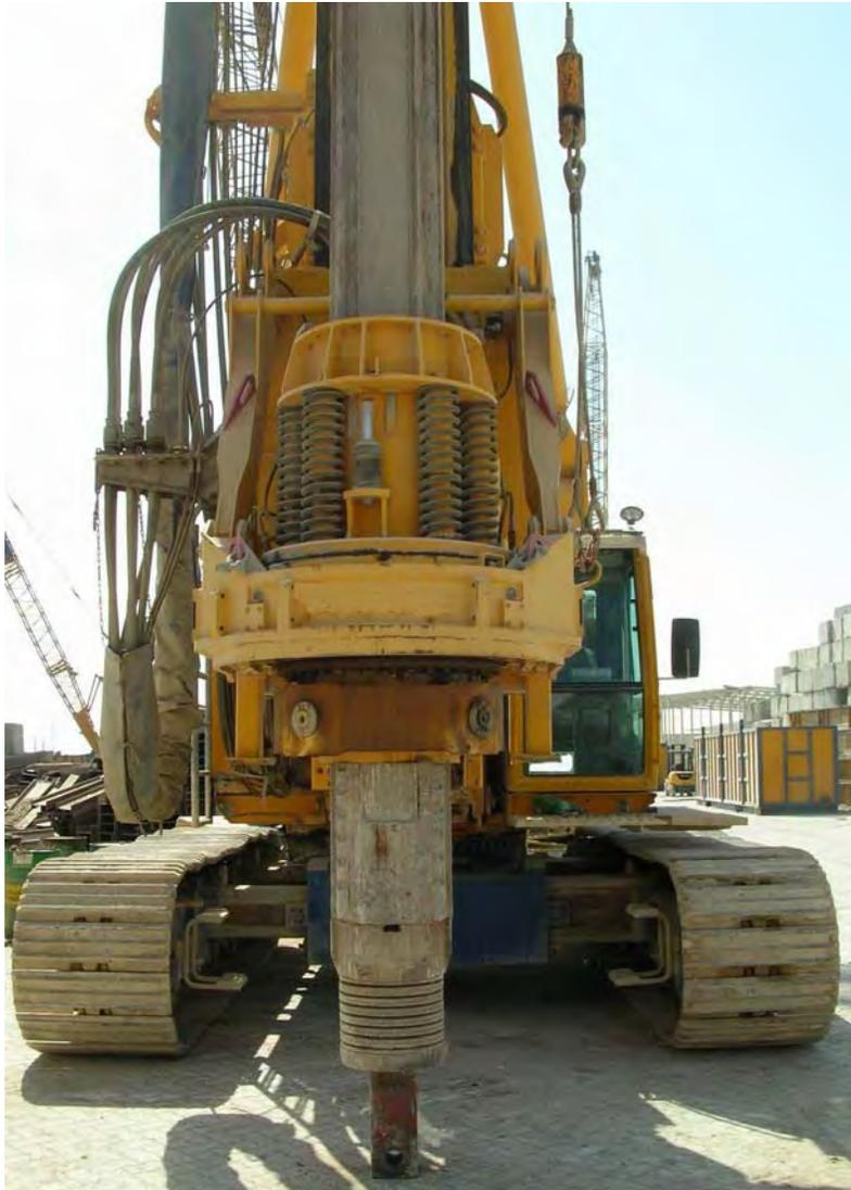
در این روش، خاک طی یک فرآیند دورانی تراشیده شده و به وسیله مغزه گیر بیرون می آید. نمونه ها در این روش دست خوردگی کمتری دارند.
