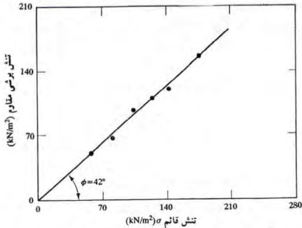
تعیین پارامترهای مقاومت برشی برای ماسه خشک با استفاده از نتایج آزمایش برش مستقیم
