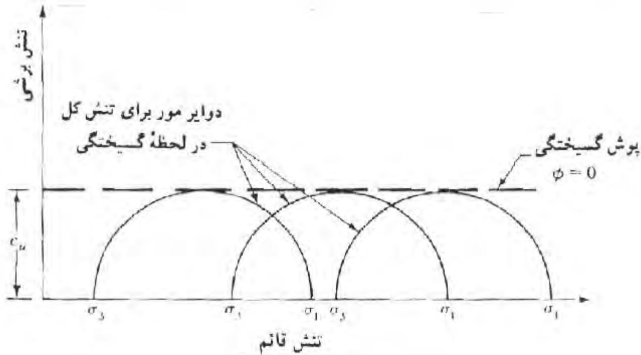
دوایر مور تنش کل و پوش گسیختگی ( $\phi = 0$ ) که از آزمایش تحکیم نیافتۀ زهکشی نشده به دست آمده است.
