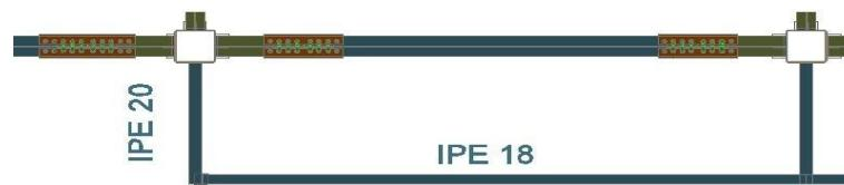
IPE 18 دارای ۵۸۰ کیلوگرم بر متر بار طولی ناشی از دیوار است ( Dead ) و ۸۳۰ کیلوگرم بار ناشی از زلزله قائم ( Ev ) در مرکز تیر. طول تیر برابر ۴/۹ متر می باشد. بنابراین برای  $V_u$  داریم:
