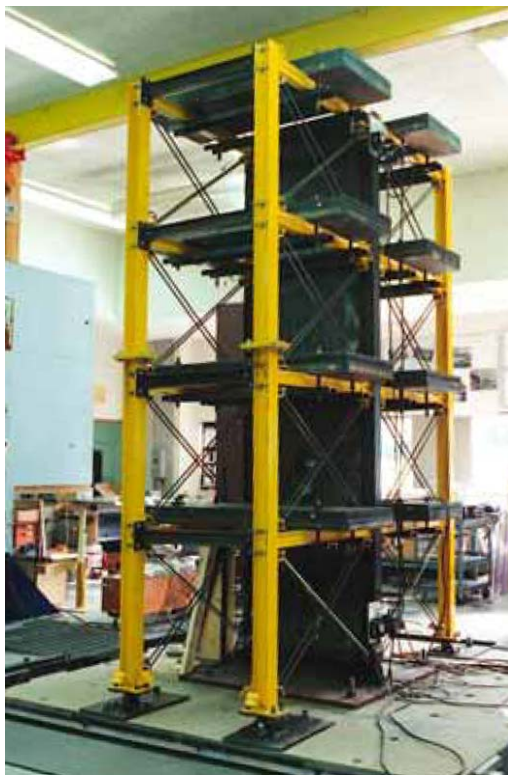
شکل ۱-۱۵: نمونه و قاب آزمایش میز لرزان نمونه چهار طبقه
