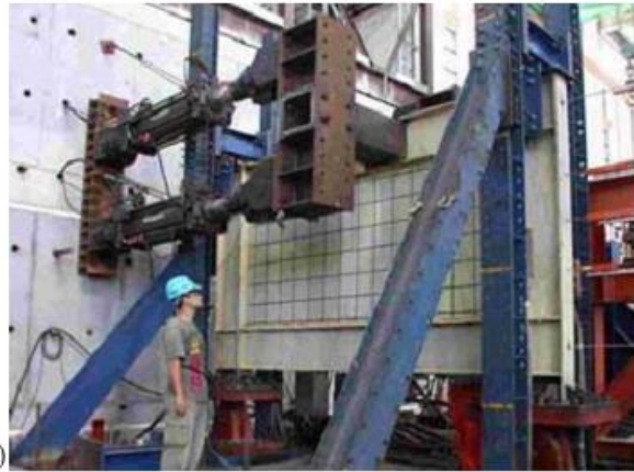
شکل 6- نمونه آزمایشگاهی دیوار برشی فولادی
